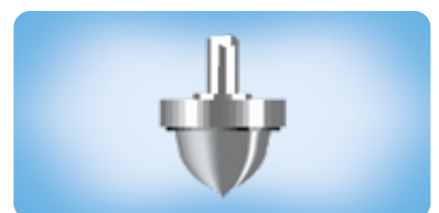
parabolförmiger Ventilstößel ermöglicht hubproportionale K_v -Änderung
